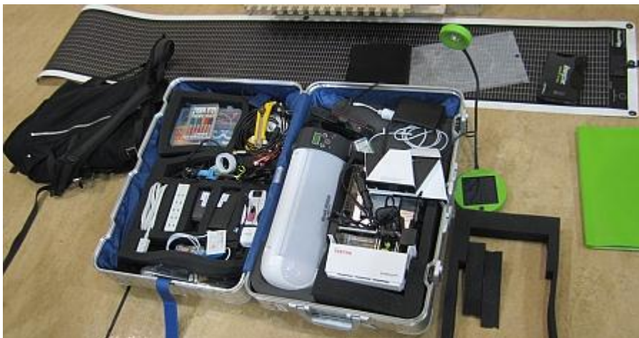
Foto - de opengeklapte koffer met daarin het mobiele mini fab lab, op de achtergrond de uitgerolde "powerfilm"; de zwarte tas links is voor de laptop (niet inbegrepen)
